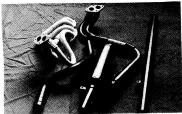
Système d'échappement complet (KIT 130 ch).
