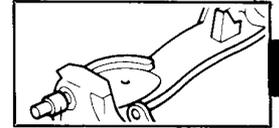
**NOTA :** Dans le porte-fusée supérieur AR, les paliers LIF (Mill. 77) ont été remplacés par un silentbloc (Mill. 78).
