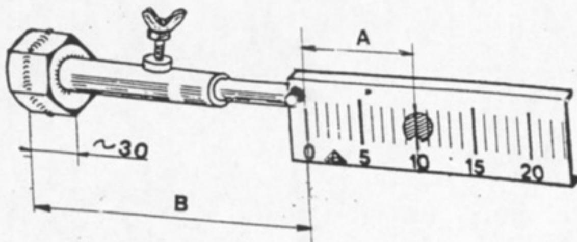
NOTA : La cote rep. B doit être identique à droite et à gauche ( cote mesurée à partir du porte fusée)
