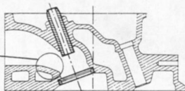
NOTA : Respecter les cotes des conduits homologués au niveau des collecteur admission et échappement en s'efforçant de centrer les orifices de la culasse avec ceux des collecteurs.
